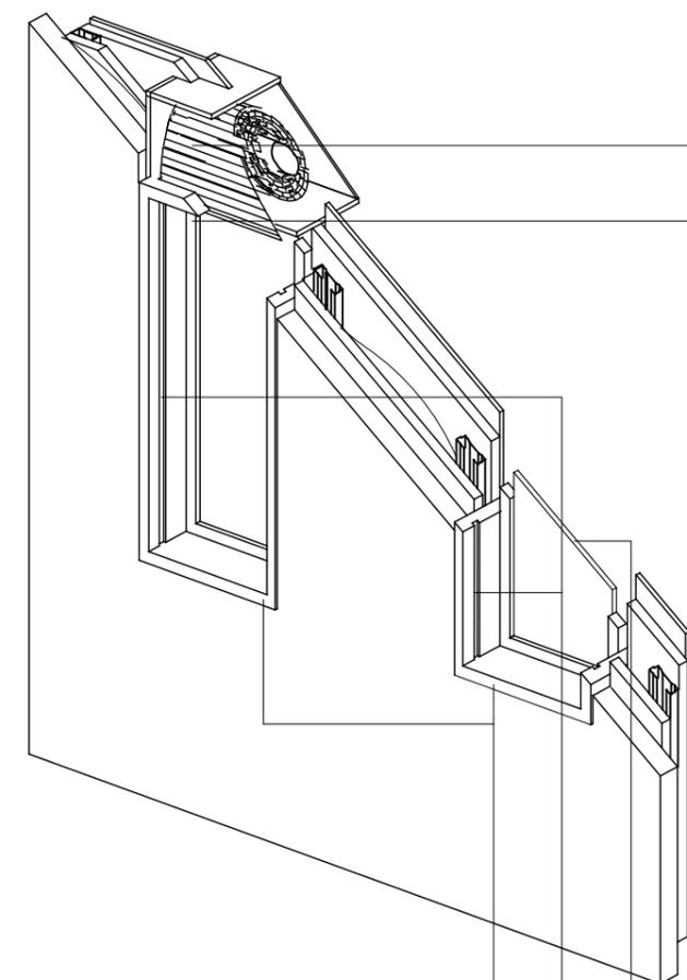
Traverso e Montante a taglio termico con battuta e funzione di controtelaio
